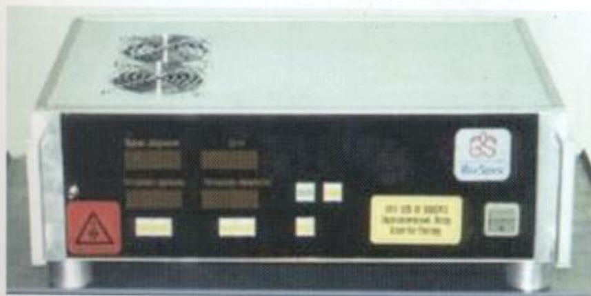
Рис. 3.1.4. Лазерный аппарат для фотодинамической терапии «LD-680-2000»
